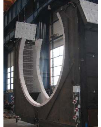
Dvoudílné předehřívací zařízení pro velké nádrže
