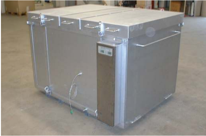
Boxy pro předehřevy a žhání ke snížení pnutí nástrojů a zápusťkových dílů
