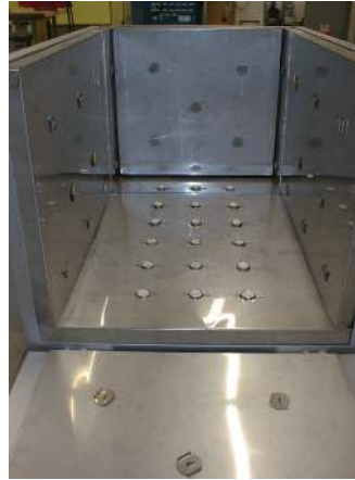
Boxy pro předehřevy a žhání ke snížení pnutí nástrojů a zápusťkových dílů
