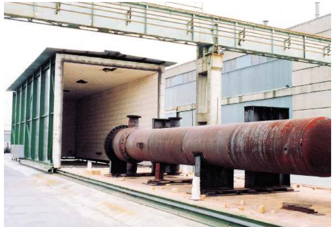
Plynová žhací pec pro žhání ke snížení pnutí velkých nádrží
