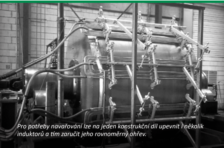
Ohřev zvenčí pomocí pevných induktorů u rotujících rour.
