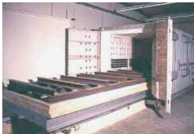
Žíhací pec v přepravním kontejneru s vozíkem, elektricky vyhřívána
