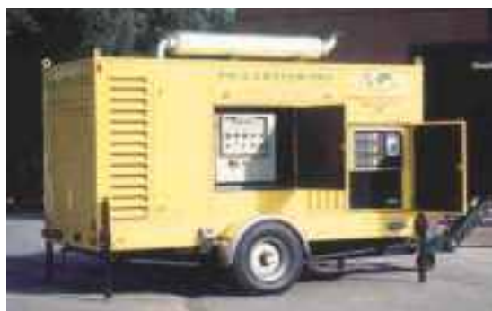
Samostatná žíhací jednotka s naftovým agregátem jako přívěs Výkon generátoru: 130 kW Výkon žíhacího zařízení: 120 kW Schváleno pro silniční provoz do rychlosti až 80 km/h. Oblast použití: Předehřívání plynových potrubí při svařování spojek tvaru T.
