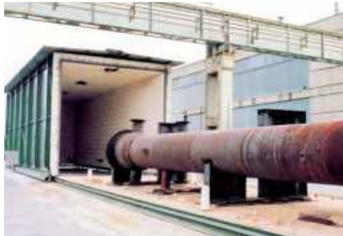
Žíhací pec vyhřívaná plynem k žíhání ke snížení pnutí u velkých nádob
